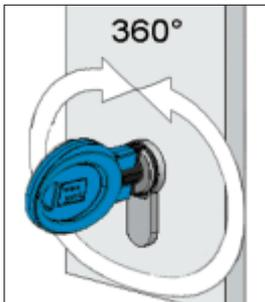
**BlueChip Schlüssel** in den Zylinder führen und den Schlüssel wie gewohnt um 360° drehen.
